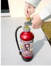
レバーを固定しているピンに指をかけます。（このとき、消火器を地面に置くと安定します）
