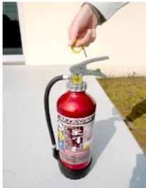
ピンを垂直方向にスパッと抜き取ります。（ピンを抜いただけでは、消火薬剤は出ないのでご安心ください）
